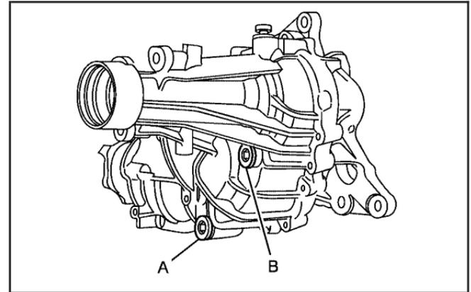
**(A) Drain Plug (B) Filler Plug**
